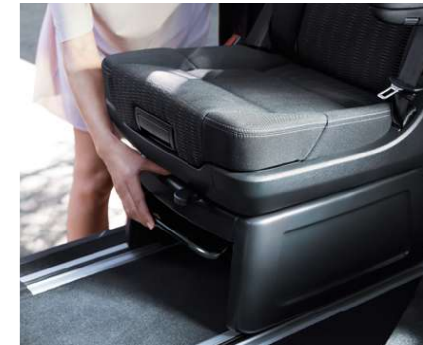
Inteligentní systém vodících lišt s otočnými sedadly zajistí neomezenou flexibilitu.
