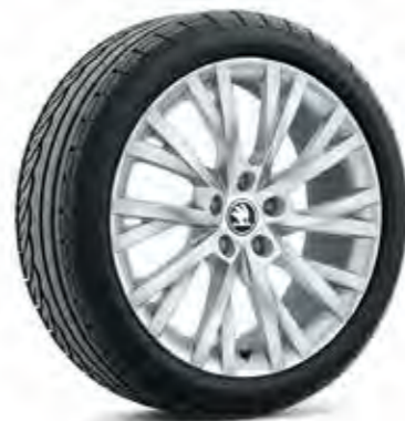
18" Kola z lehké slitiny ANTARES (disk 8J×18", pneu 235/45 R18) ET44
