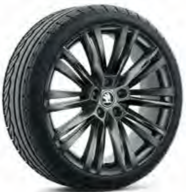
19" Kola z lehké slitiny CANOPUS černá metalická (disk 8J×19" ET44, pneu 235/40 R19)
