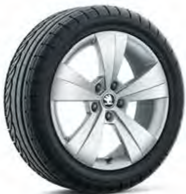
17" Kola z lehké slitiny TRITON (disk 6,5J×17" ET41, pneu 215/55 R17)
