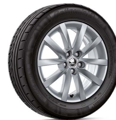
Alaris 654 071 496D 8Z8 Kolo z lehké slitiny 6J × 16" ET38 pro pneumatiky s rozměry 205/55 R16 ve stříbrné metalické barvě ŠKODA Originální příslušenství
