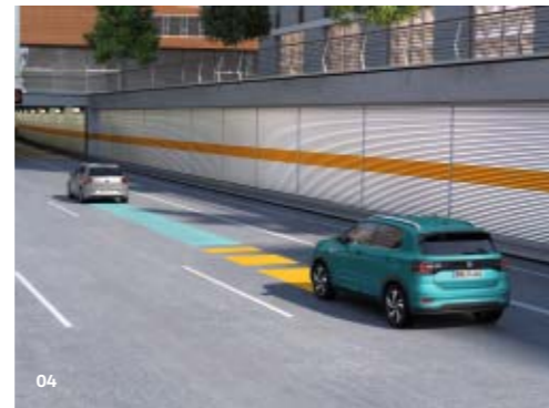
04 Adaptivní tempomat ACC přizpůsobí Vaši rychlost rychlosti vozu jedoucího před Vámi, a to až do nastaveného maximálního limitu 3) , a udržuje od něj přednastavený odstup. 1) ST SO
