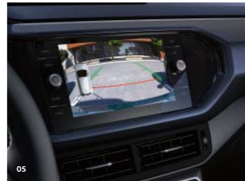
05 Zpětná kamera Vám pomáhá při couvání. 1) Obraz z kamery, jejíž objektiv snímá prostor za vozidlem, je přenášen na displej rádia nebo navigačního systému. ST SO
