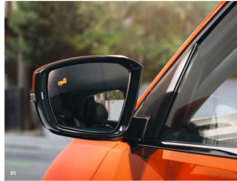
01 „Blind spot“ senzor Vás v průběhu jízdy prostřednictvím LED signalizace ve vnějším zpětném zrcátku varuje před automobily, které se nacházejí v tzv. „mrtvém úhlu“. 1) Asistent pro „vyparkování“ monitoruje při couvání z řady stojících vozidel prostor za Vaším vozem a varuje Vás před vozidly v příčném směru. 1) SO
