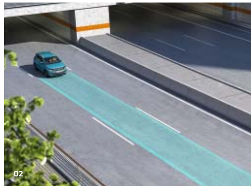
02 Asistent pro udržování vozu v jízdním pruhu „Lane Assist“ od rychlosti 60 km/h rozpozná situaci, kdy vozidlo neúmyslně opouští vyznačený jízdní pruh 1) , a prostřednictvím protipohybu řízení vrátí pozornost řidiče k dění na vozovce. 1), 2) S
