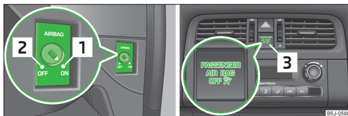
Obr. 117 Vypínač čelního airbagu spolujezdce / kontrolní světlo vypnutého, resp. zapnutého airbagu spolujezdce
